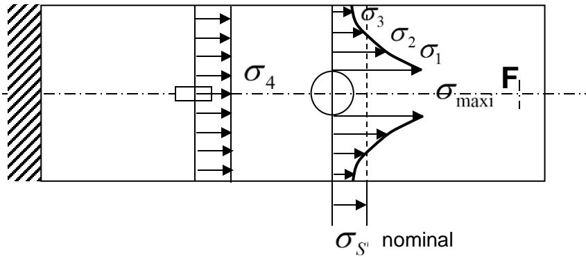
Dans la section S', la valeur de la contrainte  $\sigma$  (ou de la déformation  $\varepsilon$ ) est maximum au bord du trou, et supérieure à la contrainte nominale  $\sigma_{S' \text{ nominal}}$ . Cette contrainte nominale  $\sigma_{S' \text{ nominal}}$  peut se calculer dans le cas où la distribution des contraintes dans la section S' était uniforme :
