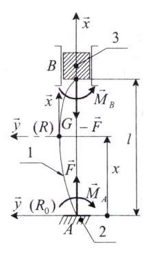
La réalisation expérimentale introduit un plan de symétrie des charges  $(A, \vec{x}, \vec{y})$ . La liaison 3-1 est telle que la résultante du torseur de liaison est parallèle à  $(B, \vec{x})$ .
